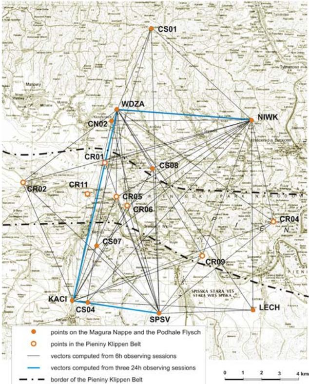
Fig. 3.2.12. GPS network in Pieniny Klippen Belt
